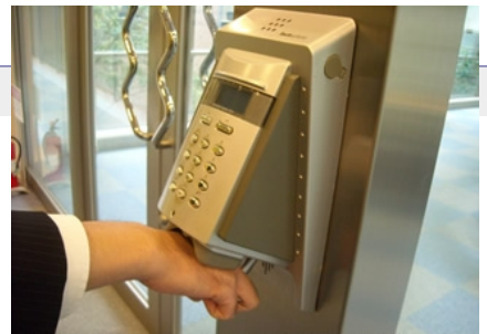
例えばセキュリティ対策の1つとして静脈認証システムによる入退室管理を徹底。各所で独自の厳しいルールを運用し情報管理に万全の体制を実現されています
