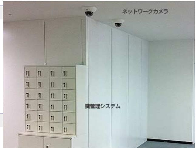
監視カメラシステムの設置例。鍵管理システムと連動し、鍵が使用されると同時にネットワークカメラが録画を開始します。
