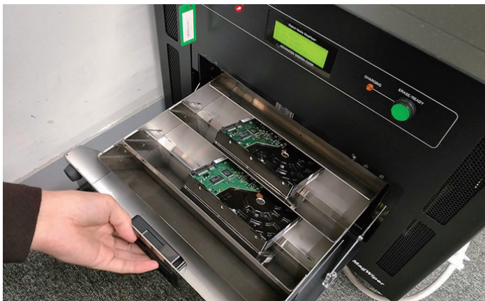
「MagWiper All-In-One MW-30000X」では、B4/A4サイズのノートPCを大型チャンバーにそのまま入れ磁気データ消去が可能。ノートPCで一般的に使われている2.5インチHDDの場合、最大51台、3.5インチHDDは最大14台に対応する。磁気消去ログ管理システム「OP-MW-LMS」（別売）で消去証明書も作成できる
