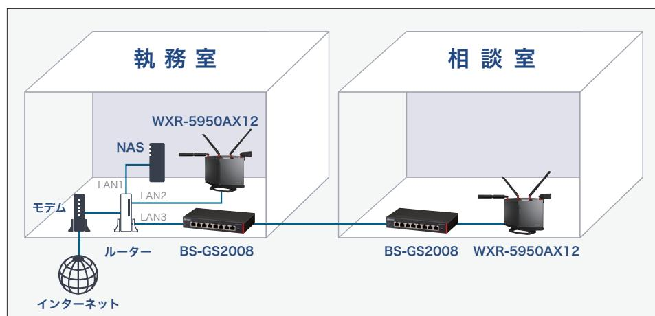
高速かつWi-Fiの安定稼働が可能な、次世代規格Wi-Fi 6(11ax)に対応した「WXR-5950AX12」を採用。執務室と相談室をつなぐ基幹ネットワーク部分は、高信頼・長期保証の法人向けスイッチ「BS-GS2008」を採用。
