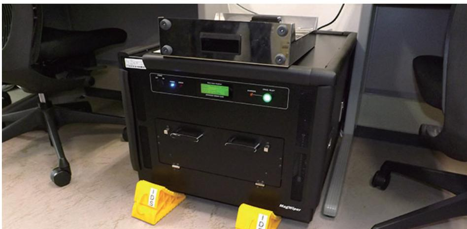
作業フローに合わせて機器が設置され、確実に全てを消去する工夫がなされている。また、データセンター内などでの移動に対応するため、機器の角にクッションを装着したり、留め具を併用したりするなど安全面も考慮して機器を使用している。
