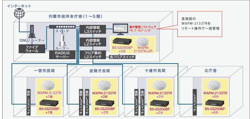
Web会議・説明会での利用を目的に、バッファローの無線LANアクセスポイントを用いて本庁舎を含む関連施設に新たなネットワーク環境を構築。各施設の無線LANアクセスポイントは「WLS-ADT/LW」により一括管理。
