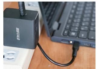
出力電力は最大45W。高負荷でも表面温度が50℃を超えない安全設計で、低温やけどのリスクを低減
