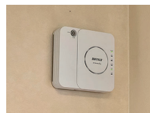
PoE給電が可能な「WAPS-1266」。小型筐体のため、配線も目立たずに設置することが可能。
