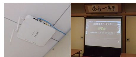
(左) プロジェクター設置場所が見通せる位置に「WAPM-1266R」を設置。(右) 地蔵寺では安定して法要の撮影とネット配信ができるように。
