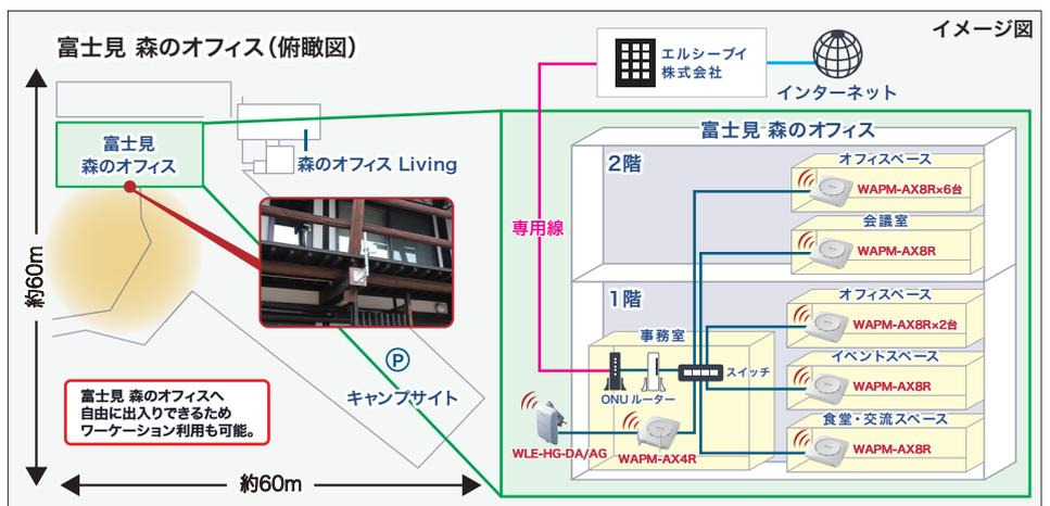
専用線とWi-Fi 6(11ax)対応の無線LANアクセスポイントにより、安定・高速性に優れたネットワーク環境を構築。施設内には「WAPM-AX8R」を適所に設置し、屋外には「WAPM-AX4R」と屋外用アンテナ「WLE-HG-DA/AG」でWi-Fi 6(11ax)を提供。
