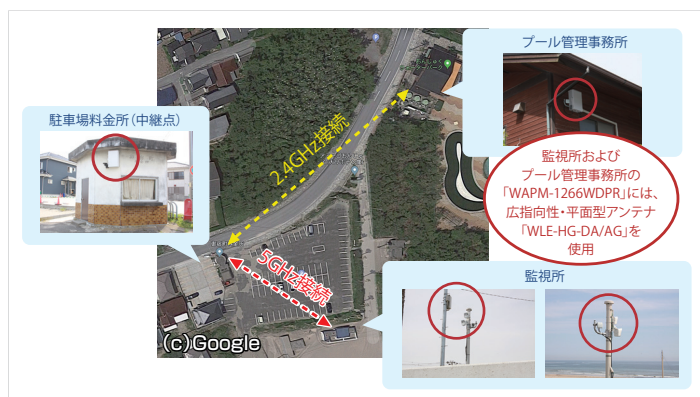
御宿町の離岸流自動検知システムで用いられた無線LANネットワーク構成
