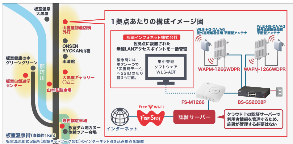
「WAPM-1266WDPR」やその他の機器を防護ケースに収容することで屋外設置に対応。
