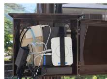
「WAPM-1266WDPR」やその他の機器を防護ケースに収容することで屋外設置に対応。
