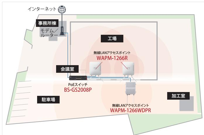
クラフト新工場のWi-Fi環境。2台の「WAPM-1266R」と1台の「WAPM-1266WDPR」で、工場、加工室、駐車場を含む敷地全体をカバーしている。工場会議室に設置されている「BS-GS2008P」1台で3台の無線LANアクセスポイントへ給電。事務所棟内は、モデム／ルーター搭載のWi-Fi機能でカバーしている。
