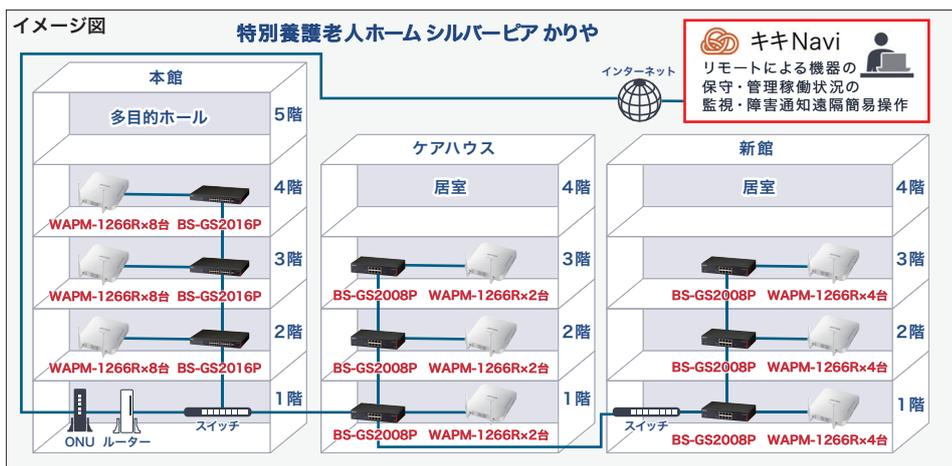
施設内の各居室で接続可能なWi-Fi環境を構築するために複数台の無線LANアクセスポイントを導入。保守・管理には「キキNavi」を活用し、PoEスマートスイッチを含むWi-Fi機器を一元管理している。
