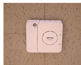
天井に設置された、法人向け無線LANアクセスポイント「WAPS-1266」。
