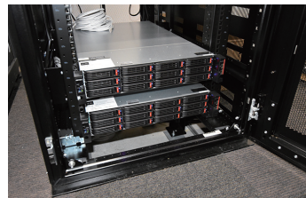
2台のTS51210RH4812。1台はRAID 6構成、もう1台はバックアップ機。両機器間は10GbEで接続されている。
