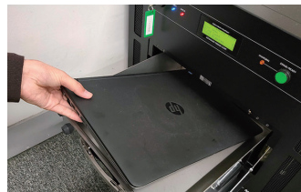
廃棄するノートPCからHDDを取り出す手間が掛からず、スピーディーにデータを消去できる
