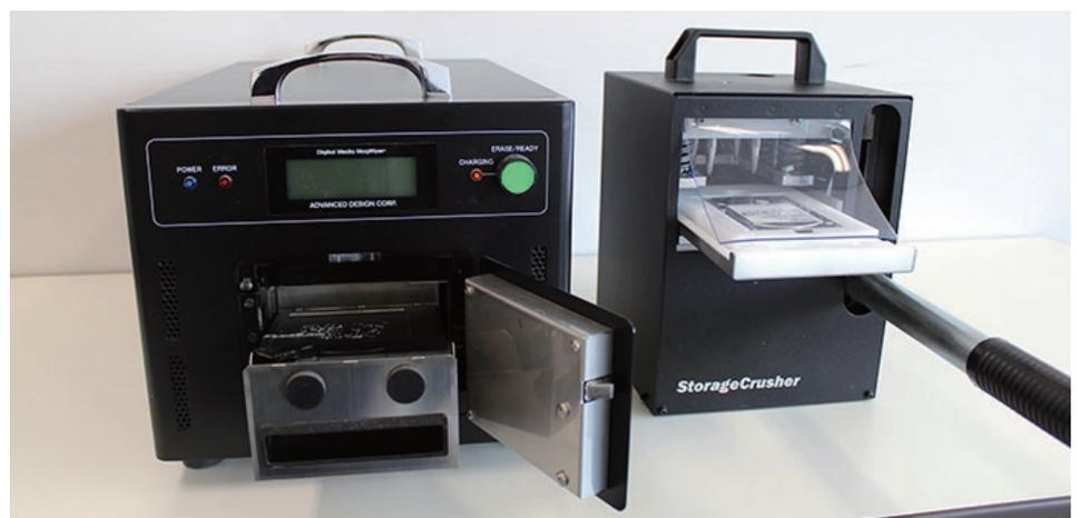
主要サーバーおよび業務パソコンの更新にあわせて磁気データ消去装置と物理破壊装置を導入。磁気消去と物理破壊を組み合わせた運用により、年度切り替えに伴う人事異動やPC故障時などに随時消去処理を行っている。
