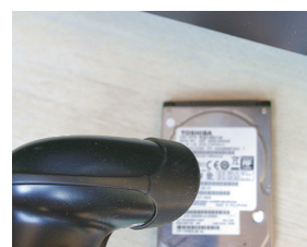
管理システムへの登録は、ハードディスクのバーコードを読み取るだけで登録可能
