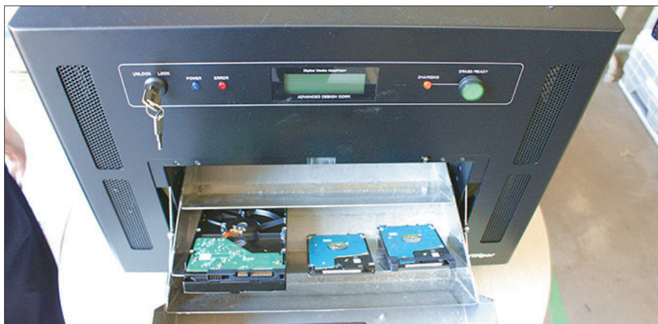
「MagWiper MW-30000X」は蓄電時間を含めても数十秒でデータ消去が完了し、ハードディスクに多い垂直磁気記録方式にも対応するパワーを兼ね備えている。磁気消去ログ管理システム「OP-MW-LMS」はハードディスクのバーコードを読み込むだけで証跡管理が簡単に行えるため、部門をまたぐ運用が容易になった。
