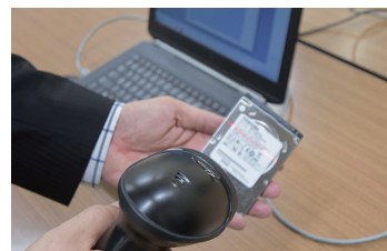
バーコードリーダーでHDD表面の個体番号バーコードを読み取るだけで消去ログとの紐づけが可能
