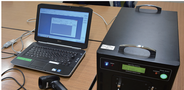
バーコードリーダーでHDD表面の個体番号バーコードを読み取るだけで消去ログとの紐づけが可能
