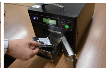
操作は、トレイにHDDを入れて「ERASE」ボタンを押すだけ。約0.1秒でデータ消去が完了する。
