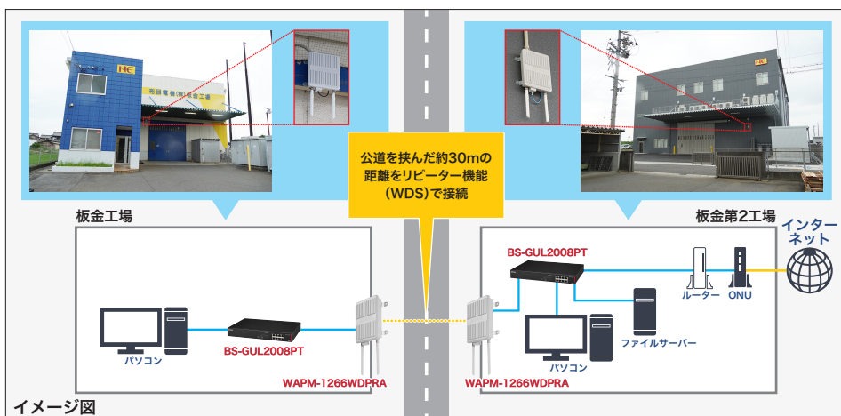
防水・防塵の耐環境性能で直射日光下にも設置可能な「WAPM-1266WDPRA」を2つの工場壁面に設置。約30mの距離をリピーター機能(WDS)で接続。2台のアンテナの高さをそろえることで、通信速度をより安定させている。
