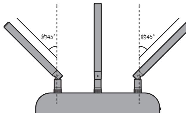
中央のアンテナはまっすぐ立て、左右のアンテナは外側に向かって斜めに傾けます。
