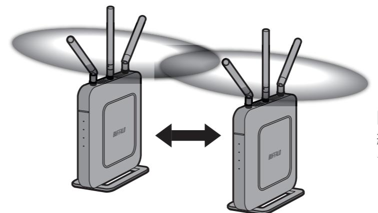
同じ階で中継機を使用しているときは、親機と中継機本体の側面同士を向かい合わせるように設置すると、より良い通信速度が得られます。
