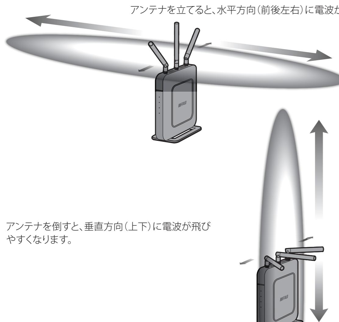
アンテナを倒すと、垂直方向(上下)に電波が飛びやすくなります。
