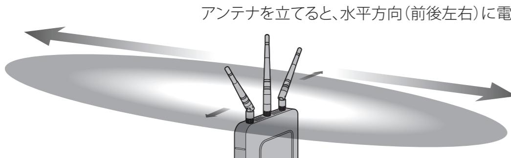
アンテナを立てると、水平方向(前後左右)に電波が飛びやすくなります。
