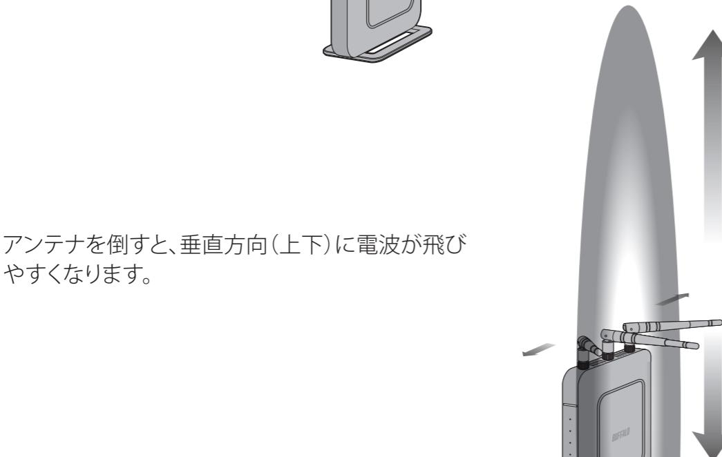
アンテナを倒すと、垂直方向(上下)に電波が飛びやすくなります。
