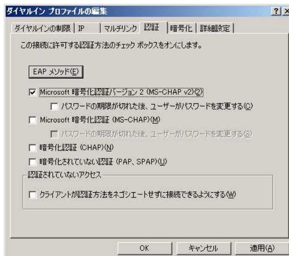
図 10 : ダイヤルインプロファイルの編集 (EAP-PEAP の場合)
