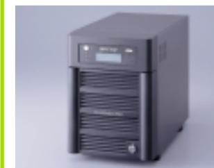
TeraStation PROは、複数の内蔵ドライブにデータを書き込んで保護するRAID機能を搭載している。そのデータ保護機能と高速性のレベルは、5つのモードの中から選択可能だ。信頼性の高さと高速性を両立させた「RAID10モード」「RAID5モード」、データ保護を優先した「ミラーリング(RAID1)モード」、高速性を重視した「ストライピング(RAID0)モード」、あるいは使い勝手のよさを重視した「通常モード」など、自社の環境に最適なモードを選びたい。
