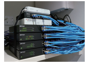
スマートスイッチのVLAN機能で2つの回線を3つのセグメントに切り分けている
